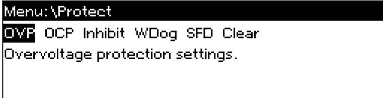
이 모델의 OVP 설정은 24V로 설정되어 있습니다. 숫자 입력 키를 사용하고 Enter 키 및 [Select] 선택 키를 눌러 OVP 설정을 변경할 수 있습니다. 미터 화면으로 돌아가려면 [Meter] 미터 키를 누릅니다.
