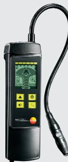
testo 316-2는 사용자 친화적이고 통합 펌프, 감지된 가스 농도의 시각적인 디스플레이 및 측정 배터리의 빠른 확인에 적합합니다.
