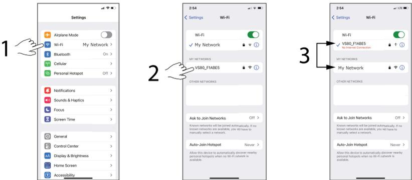
그림 12.3 스마트 기기 설정 예. 1단계: 먼저 스마트 기기에서 Wi-Fi 설정을 누릅니다. 2단계: 다음으로 사용 가능한 네트워크 목록에서 VS80을 누릅니다. 3단계: 이제 VS80이 연결된 네트워크가 되고, 개인 네트워크(이 예에서는 'My Network')가 사용 가능한 네트워크 목록에 있지만 더 이상 연결되지는 않습니다. 개인 네트워크를 다시 사용하려면 사용 가능한 네트워크에서 네트워크 이름을 누르기만 하면 됩니다. 이 경우 VS80 연결이 끊어집니다.
