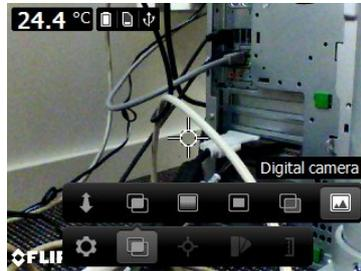
좋은 합성 이미지를 표시하려면(열화상 MSX, Picture-in-picture 및 열화상 혼합 모드) 카메라가 디지털 카메라 렌즈와 적외선 렌즈 간에 생기는 작은 차이를 보정할 수 있도록 조정해야 합니다. 카메라가 이미지를 정확하게 조정하려면 조정 거리(물체까지의 거리)가 필요합니다.
